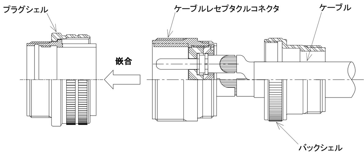
5-11. バックシェルとケーブルクランプボディを締め付けます。
